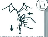
ДЛЯ РУБАШКИ: ЗАКРЕПИТЕ МИКРОФОН В ФИКСАТОРЕ И РАЗМЕСТИТЕ ЕГО МЕЖДУ ВЕРХНИМИ ПУГОВИЦАМИ РУБАШКИ МЕЖДУ СЛОЯМИ ТКАНИ. ЗАКРЕПИТЕ ФИКСАТОР У ПУГОВИЦЫ И ОТРЕГУЛИРУЙТЕ НАТЯЖЕНИЕ КАБЕЛЯ
